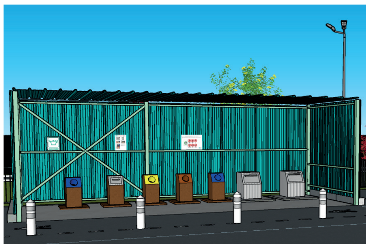
Zone de dépôt des «petits flux» et son dispositif de vidage par bornes
