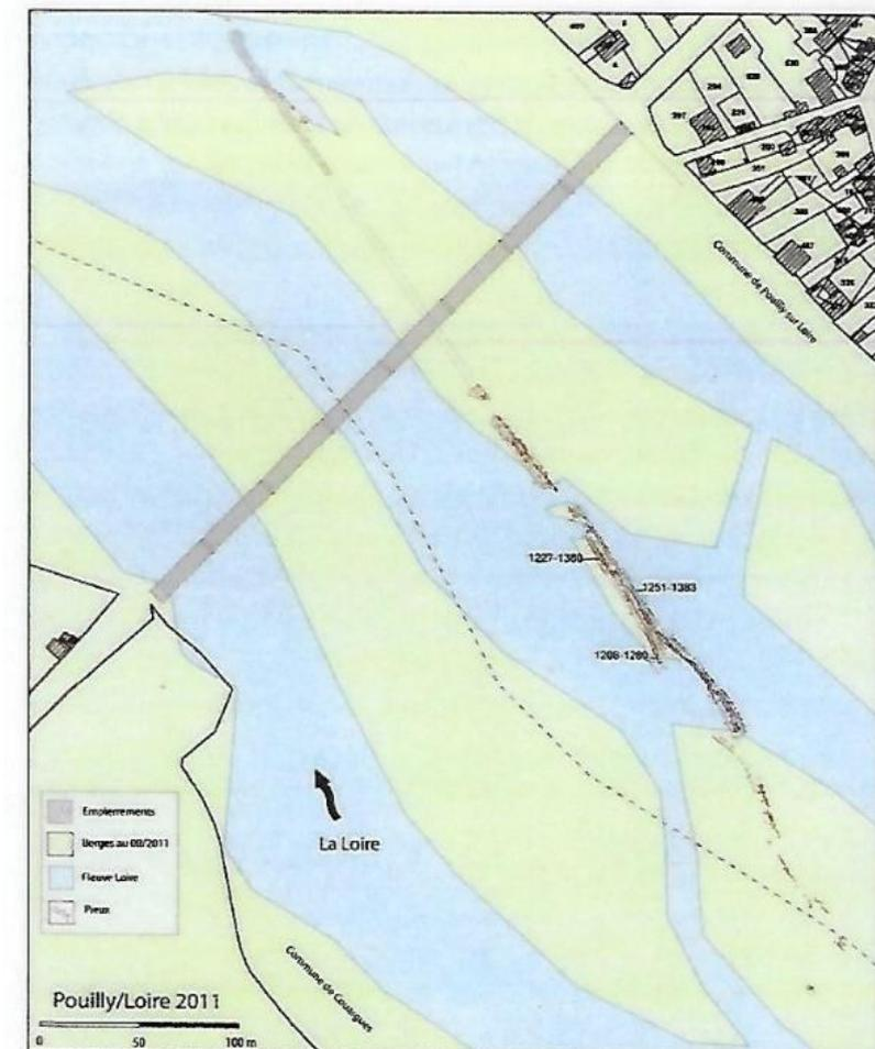
*Pouilly-sur-Loire. Plan de la digue constituée de pieux et de pierres visibles en aval et en amont du pont routier, replacée sur le fond cadastral. Les résultats calibrés des trois dates <sup>14</sup>C ont été replacés sur le plan. Relevé de terrain 2011
