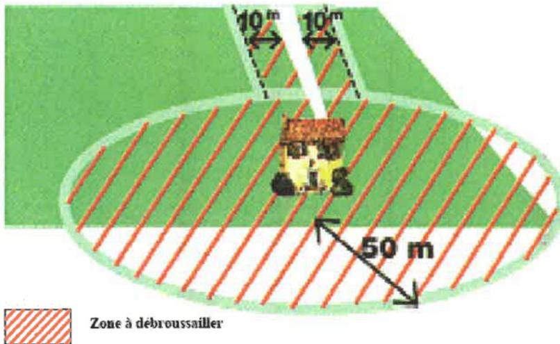
➤ Autour de toute installation ou construction le débroussaillage est à opérer dans un rayon de 50 m.
