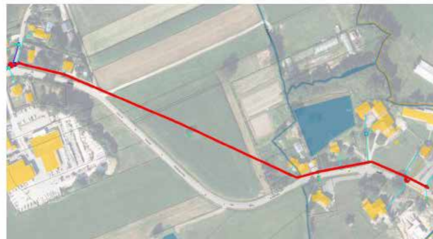
Figure 3 : Renforcement de conduite et mise en domaine public de la conduite Rue du Moulin
